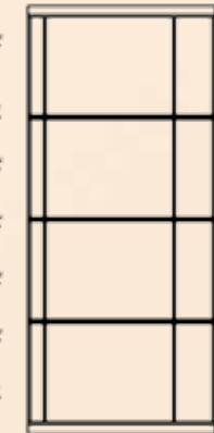
EXAMPLE CENTER WALL SECTION 4\frac{1}{2}'' + 50\frac{1}{2}'' + 50\frac{1}{2}'' + 50\frac{1}{2}'' + 50\frac{1}{2}'' + 4\frac{1}{2}'' = 210\frac{1}{2}''
